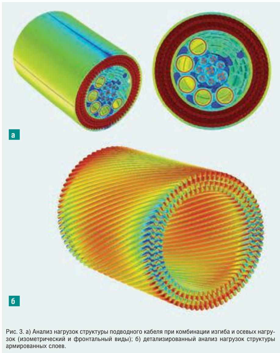
Рис. 3. а) Анализ нагрузок структуры подводного кабеля при комбинации изгиба и осевых нагрузок (изометрический и фронтальный виды); б) детализированный анализ нагрузок структуры армированных слоев.
