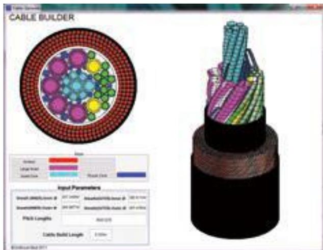
Рис. 2. Скриншот программы Cable Building, на котором изображена схема сечения (слева сверху), входные параметры (внизу) и секционная 3D-структура (справа). Цветом выделены различные компоненты подводного кабеля, включая бронированные слои (красный), шланги различного типа (высокого давления (пурпурный), среднего давления (желтый), и низкого давления (зеленый)), центральные для передачи данных и энергии (голубой) и различные наполнители (синий).
