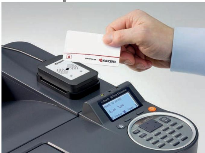
KNM состоит из серверной части и терминалов, которые ставятся на принтеры и МФУ. В зависимости от лицензии, программа может управлять не только печатью, но и сканированием.
