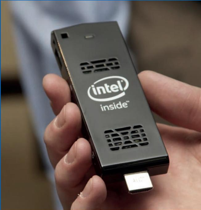
Возможности Intel Compute Stick практически аналогичны NUC. Однако здесь нет такого количества портов расширения, и конфигурация изначально задана производителем. Основная область применения устройств – smart-TV.
